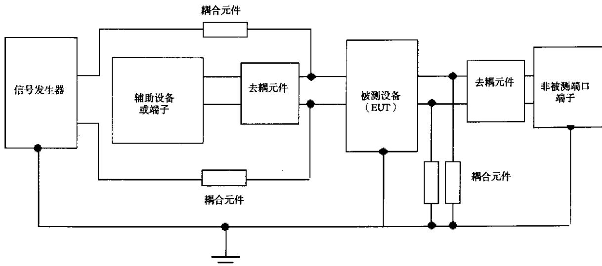
图 A.5 典型试验设置方框图
