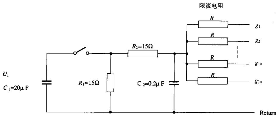
图 A.1 10/700μs 电压信号发生器
